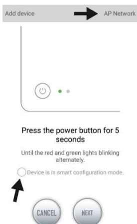
Рис. 3: желаемый режим подтверждается касанием кружка над нижней стрелкой. Нажимая «AP Network» или «Smart Network» рядом с верхней стрелкой (стрелка недоступна в приложении), можно переключаться между двумя режимами. (Здесь необходимо выбрать «Smart Configuration Mode»).
