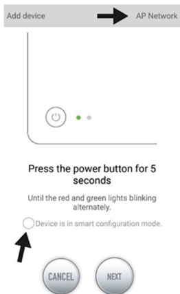
Fig. 3: Tocando el círculo sobre la flecha inferior, se confirma el modo deseado. Al tocar "Red AP" o "Red Inteligente" junto a la flecha superior (la flecha no está presente en la APP), puede cambiar entre los dos modos.
