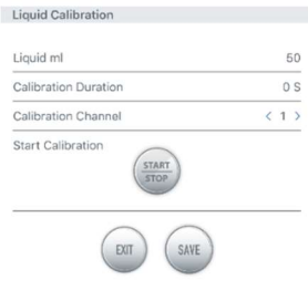
Abb. 9: Ein Beispiel: Wenn der Benutzer möchte, dass die Pumpe automatisch etwa 40~60 ml der Flüssigkeit dosiert, sollten 50 ml als Kalibrierungsvolumen eingegeben werden. Die Kalibrierungsdauer wird automatisch im Speicher abgelegt.
