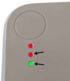
Rys. 2b: dwie dolne diody muszą jednocześnie migać jeśli chcesz połączyć się bezpośrednio do pomp.
