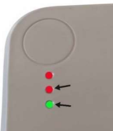
Рис. 2b: Оба нижних LED индикатора должны одновременно мигать. Только в этом случае возможна связь с помпой напрямую.
