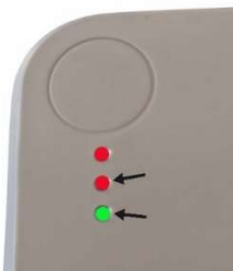
Fig. 2b: Les deux LEDs inférieures doivent clignoter simultanément si vous voulez vous connecter directement à la pompe.
