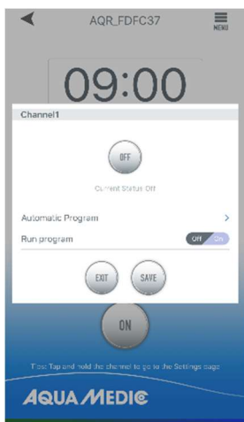
Fig. 13: Después de la configuración, ponga el interruptor del temporizador en "ON" y guarde con "SAVE".
