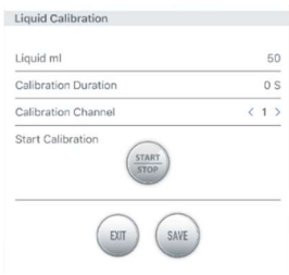
Fig. 9: Por ejemplo, si el usuario quiere que la bomba dosifique automáticamente unos 40 ~ 60 ml del líquido, entonces deberá ingresar 50 ml como volumen de calibración. El tiempo de calibración se guarda automáticamente en la memoria.
