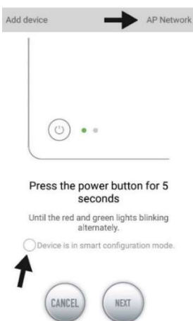
Abb. 3: Indem man auf den Kreis oberhalb des unteren Pfeiles tippt, wird der gewünschte Modus bestätigt. Durch Antippen von „AP Network“ oder „Smart Network“ neben dem oberen Pfeil (der Pfeil ist nicht in der APP vorhanden), kann man zwischen den beiden Modi hin und her schalten. ( Hier muss der „Smart Configuration Mode“ ausgewählt sein, das heißt „AP Network“ angezeigt werden. ) Das AP-Netzwerk steht nicht zur Verfügung!!
